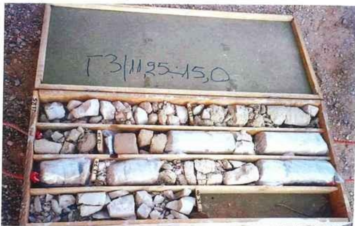
Δείγματα Γεώτρησης Γ3 από βάθος 11.25 – 15.00m
