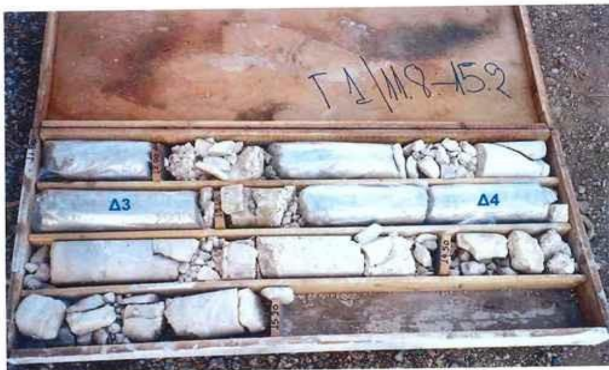
Δείγματα Γεώτρησης Γ1 από βάθος 11.80 – 15.20m
