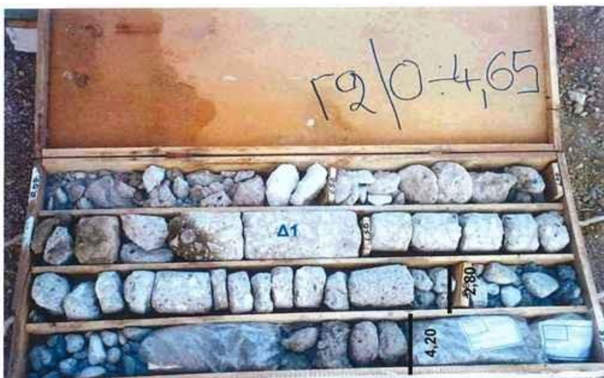
Δείγματα Γεώτρησης Γ2 από βάθος 0.00 – 4.65m
