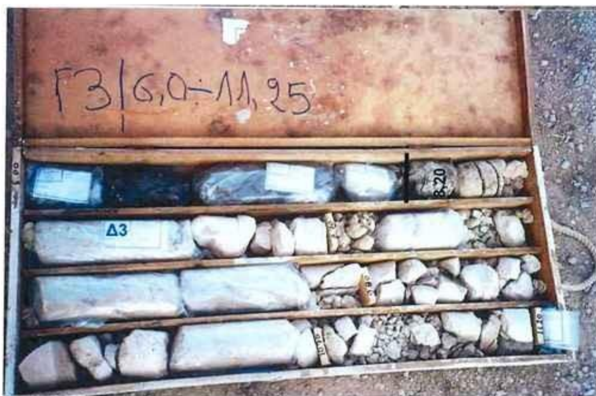
Δείγματα Γεώτρησης Γ3 από βάθος 6.00 – 11.25m
