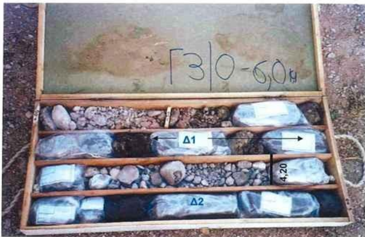
Δείγματα Γεώτρησης Γ3 από βάθος 0.00 – 6.00m
