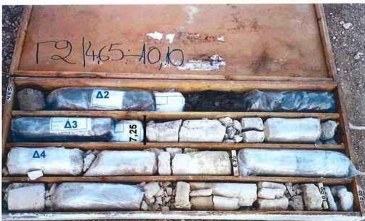
Δείγματα Γεώτρησης Γ2 από βάθος 4.65 – 10.10m
