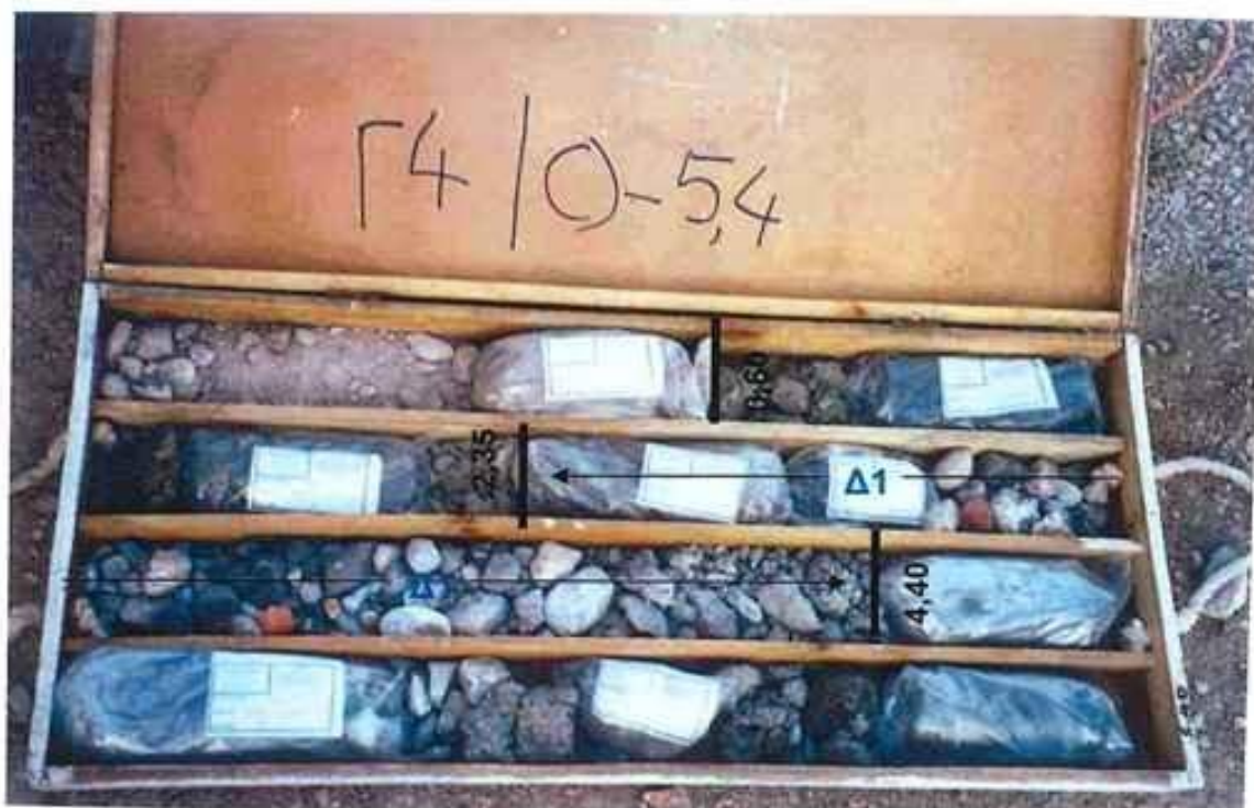
Δείγματα Γεώτρησης Γ4 από βάθος 0.00 – 5.40m
