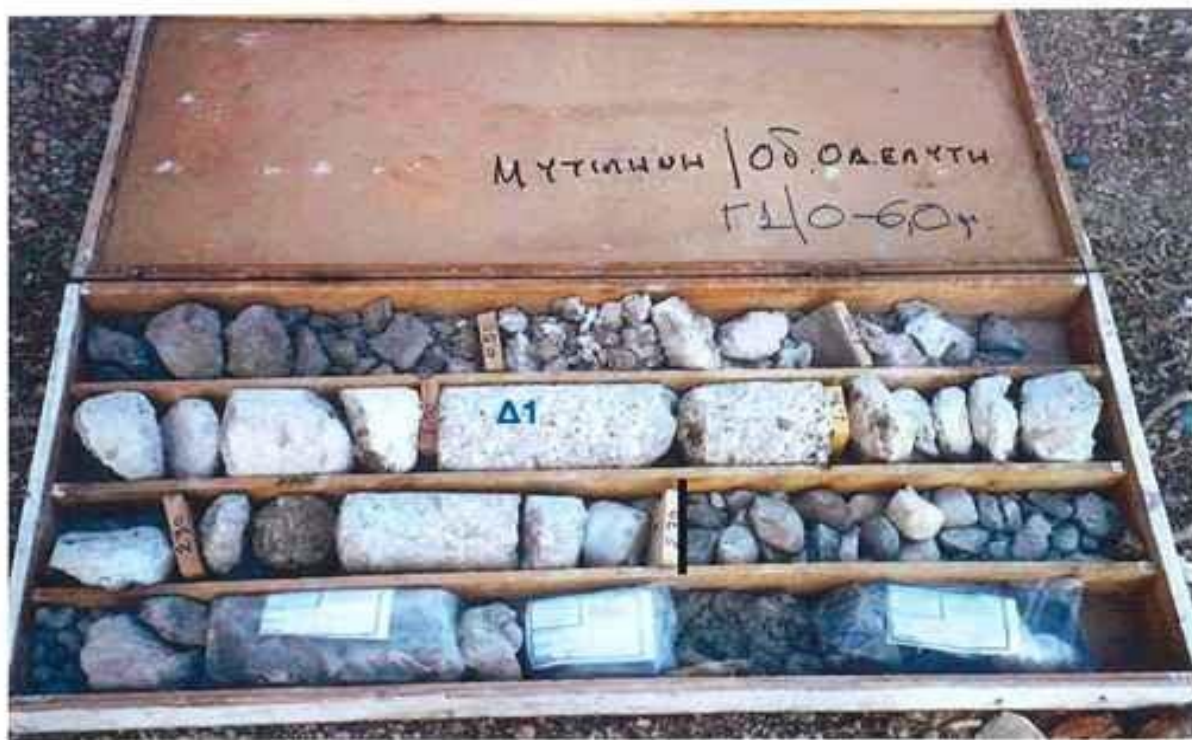
Δείγματα Γεώτρησης Γ1 από βάθος 0.00 – 6.00m
