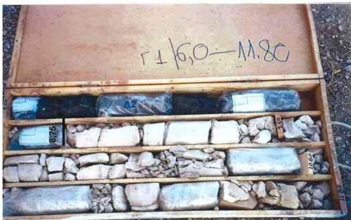
Δείγματα Γεώτρησης Γ1 από βάθος 6.00 – 11.80m
