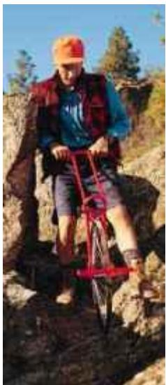
Στις προμετρήσεις χρησιμοποιήθηκε ο **ειδικός τροχός μέτρησης αποστάσεων (οδόμετρο)** Measuring Wheel M7-1414 Γερμανικής προσελεύσεως με ακρίβεια εκατοστού (1cm) και συνολικού μήκους καταγραφής 10 Km (βλ. φωτογραφία).
